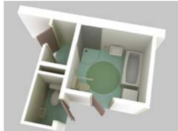
Obr. č. 4 – Dodatočným umiestnením toalety sa kúpeľňa zmení na bezbariérovú za predpokladu, že sa na stenu sprchovacieho kúta namontujú držadlá a sklopné sedadlo
