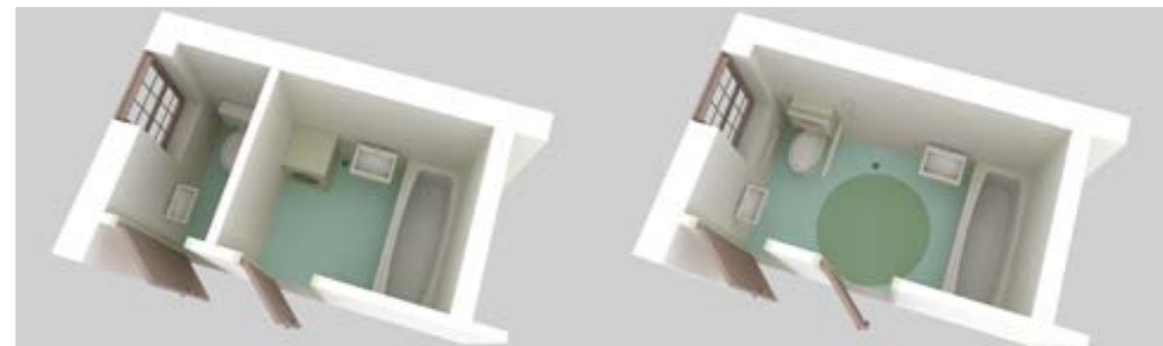
Obr. 10 Upraviteľná kúpeľňa – prístup pre osobu na vozíku sa zabezpečí formou odstránenia priečky. Kúpeľňa musí mať podlahový vpust, aby bolo možné realizovať sprchu, ak by bolo potrebné.
